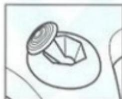
Si le levier de contrôle est tenu à un certain angle (comme sur l'illustration de gauche) lors de la mise en marche, cette position deviendra la position neutre et les jeux utilisant le levier de contrôle ne fonctionneront pas correctement.
