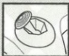
Si le levier de contrôle est maintenu dans un certain angle (cf photo) lors de la mise en marche, cette position faussée deviendra position neutre et les jeux utilisant ce levier de contrôle ne fonctionneront pas normalement.
